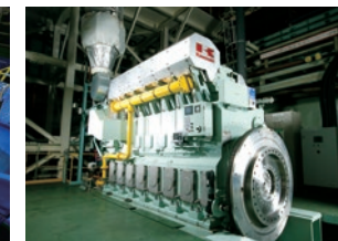
ハイブリッド推進システム船に 搭載される天然ガス専焼エンジン
