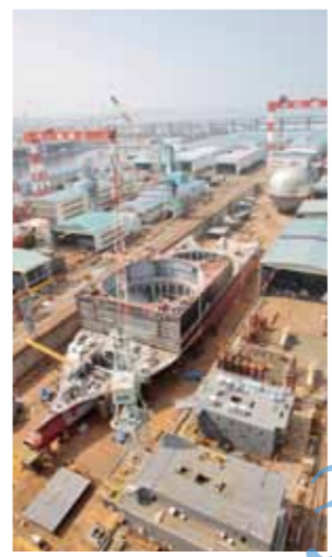
建造中のLNG運搬船
