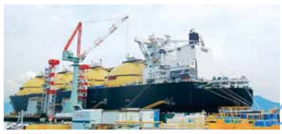
岸壁で艤装中のLNG運搬船
