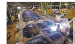
部品の溶接・組立作業
