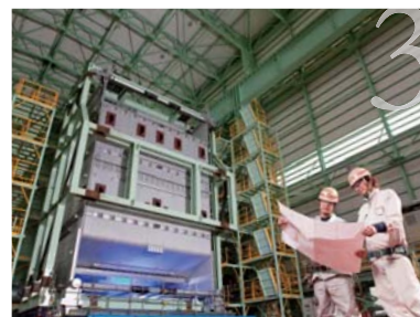
ボイラの総組立
