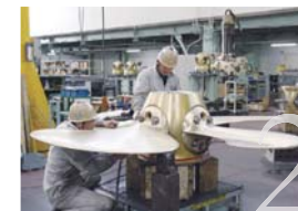
プロペラ部の組立作業
