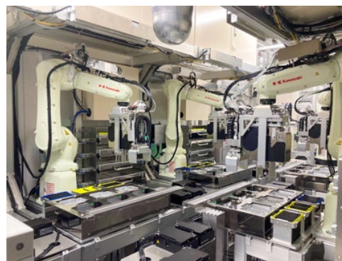
自動PCR検査ロボットシステム（左図：コンテナ内部 右図：外観）
