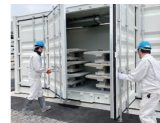
CO 2 -SUICOM 炭酸化養生槽のイメージ
