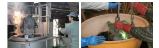
改善前:樹脂を加熱焼却 改善後:溶剤により樹脂を除去
