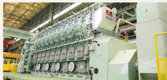
世界最高の発電効率49.5%のグリーンガスエンジン
