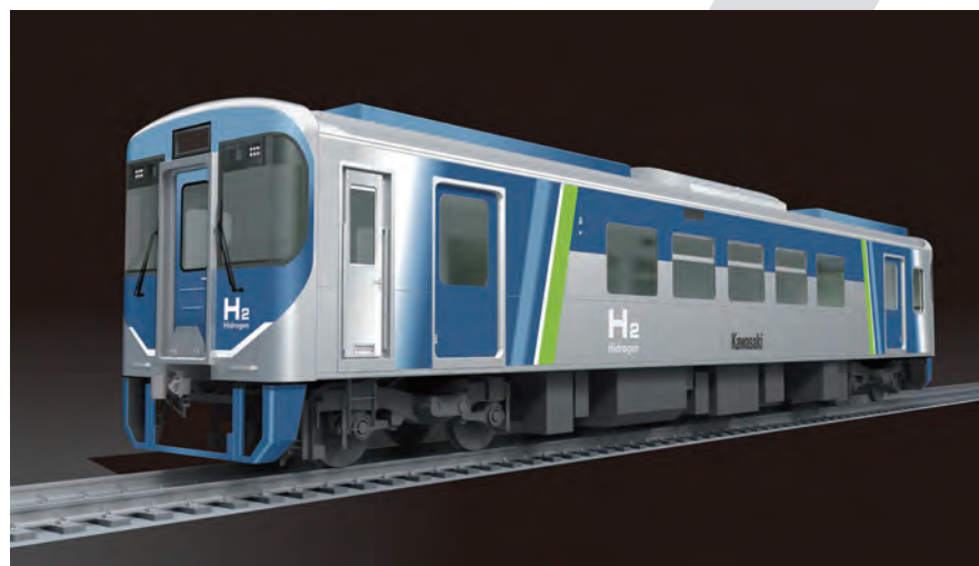
ディーゼルエンジンからの置換えが可能な水素ready車両「GreenHICE Car」
