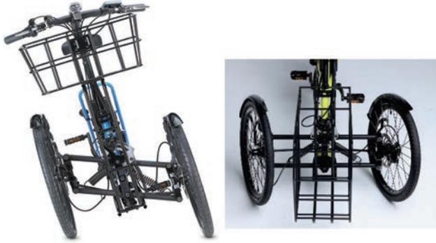
(a) 車体の傾きに同調し、車輪も傾くリンク構造
