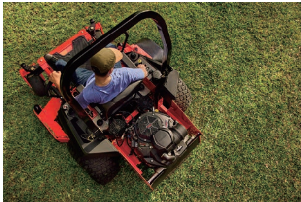
図2 「FX820V EVO」が搭載された乗用芝刈機 Fig. 2 Riding mower equipped with FX820V EVO
