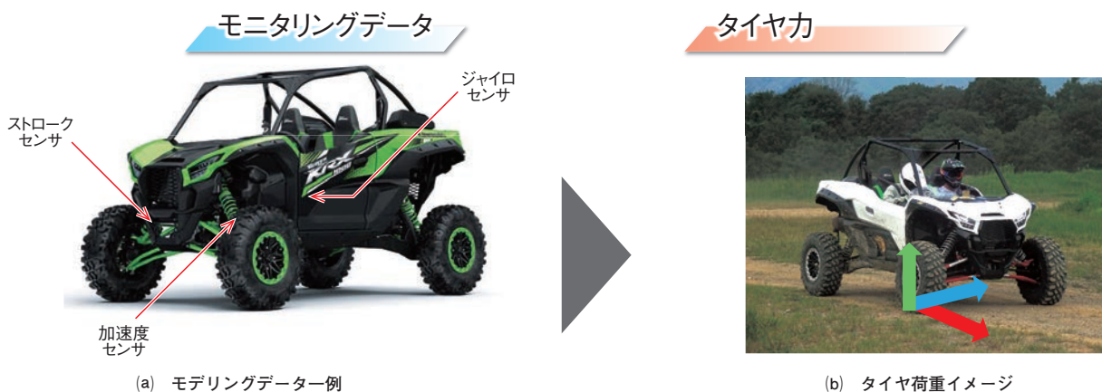
図4 タイヤ荷重推定手法 2) Fig. 4 Measurement method of the tyre force
