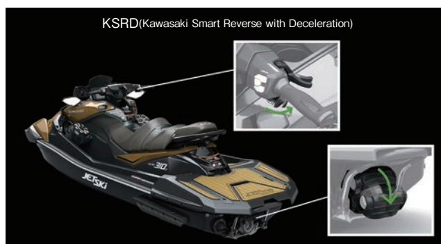
図2 KSRDのシステムのイメージ図 Fig. 2 Image of KSRD system
