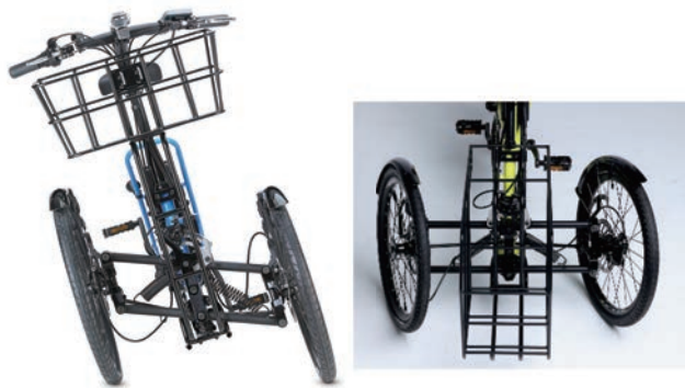
(a) 車体の傾きに同調し、車輪も傾くリンク構造
