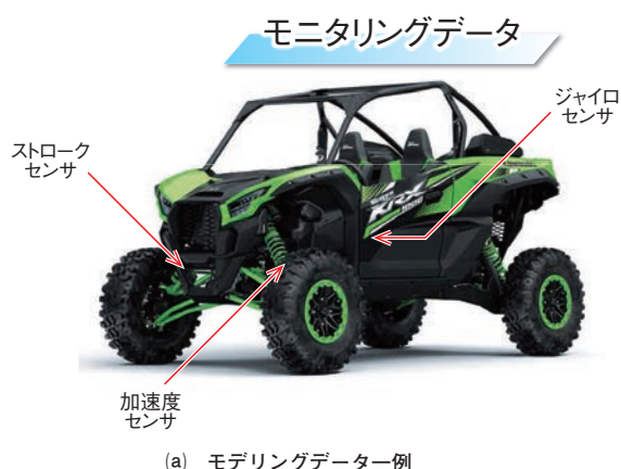
図4 タイヤ荷重推定手法 2) Fig. 4 Measurement method of the tyre force
