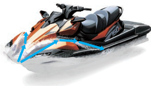
図1 船首付近にかぶった水の流れ Fig. 1 Water flow along bow
