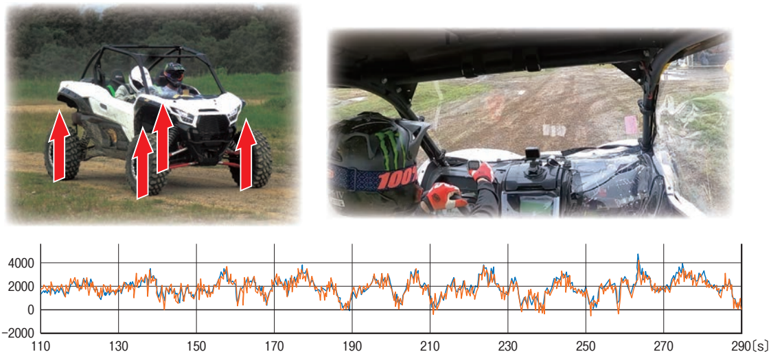
図5 タイヤ荷重推定のイメージ図 Fig. 5 Measurement of the tyre force in action
