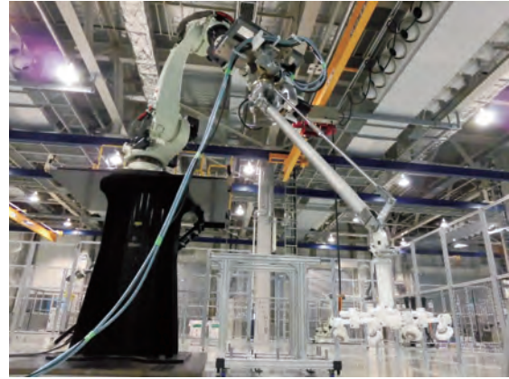
図5 産業用ロボットを使用したアーム追従動作模擬 Fig. 5 Simulation of robot arm tracking operation using an industrial robot
