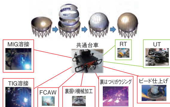
図2 球形タンクモジュール工法 高効率化技術のイメージ
