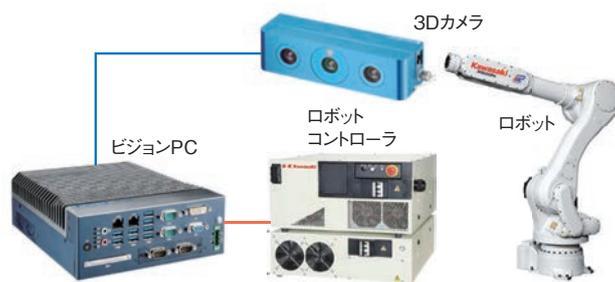
図2 デバンニングにおける「K-VStereo」のシステム構成
