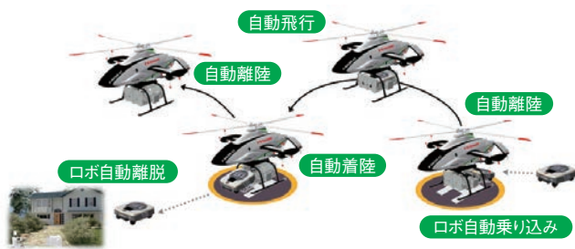
図7 「K-RACER-X1」と配送ロボットを用いたシームレス & 無人物流のデモンストレーション計画
