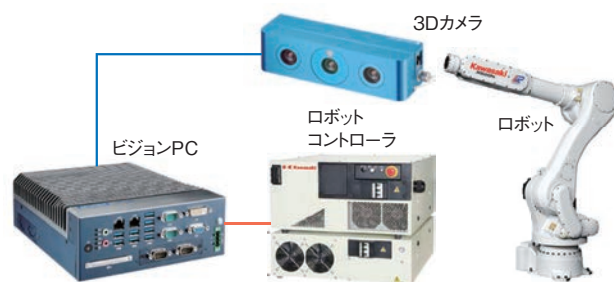
図2 デバンニングにおける「K-VStereo」のシステム構成 Fig.2 Configuration of the K-VStereo system for devanning
