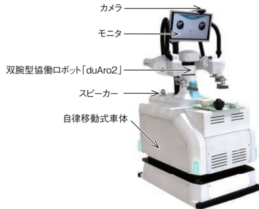
図5 「見守りロボットシステム」の構成 Fig. 5 Monitoring robot system configuration
