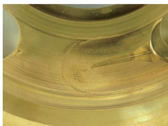
図2 バルブプレート上のキャビテーションによるエロージョンの例
