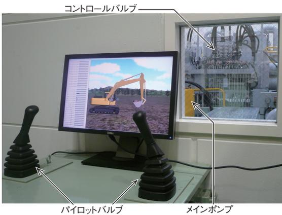
図5 油圧システム評価ベンチ「HILS」
