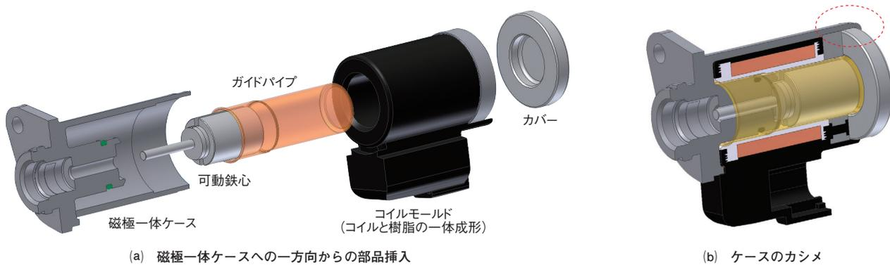
図1 新型ソレノイドの組立工程
