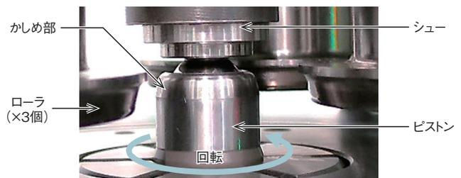
図8 ローラかしめによるピストンとシューの結合
