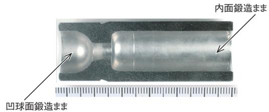
図6 鍛造ピストンの高精度内面
