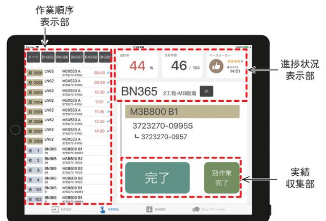
図2 作業指示システムの概要
