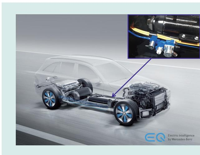
地球環境に優しい車として燃料電池車が注目されており、その動力源である燃料電池に安定して水素を供給するために、高性能な減圧弁が求められている。当社は、長年にわたる油圧機器の開発・製造から培ってきた流体制御技術をベースに、車両寿命期間である約20年にわたって水素ガスを確実に封止できる、小型・高精度で信頼性の高い減圧弁を開発した。また、それはダイムラー社に高く評価され、燃料電池車メルセデス・ベンツ GLC F-CELLに量産採用された。
