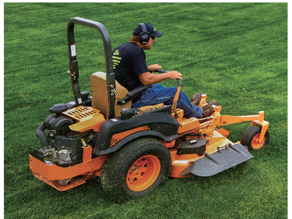
図2 「FX850V-EFI」が搭載される作業機（ZTR） Fig. 2 Riding mower mounted with FX850V-EFI (ZTR)
