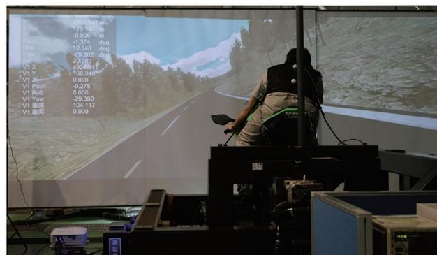
図6 ライディングシミュレーター
