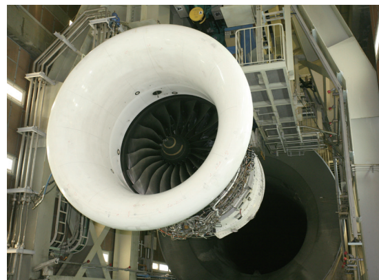
図7 テストセルに搭載された「Trent」エンジン Fig.7 Trent engine in test cell
