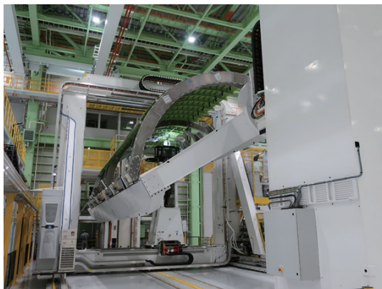
図8 リベッターによる自動化拡大 Fig.8 Enhancement of automation using a riveting machine
