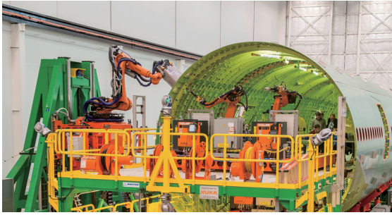
図4 ロボットを駆使した最終組立(ボーイング社内) Fig. 4 Final assembly using robots (at Boeing)
