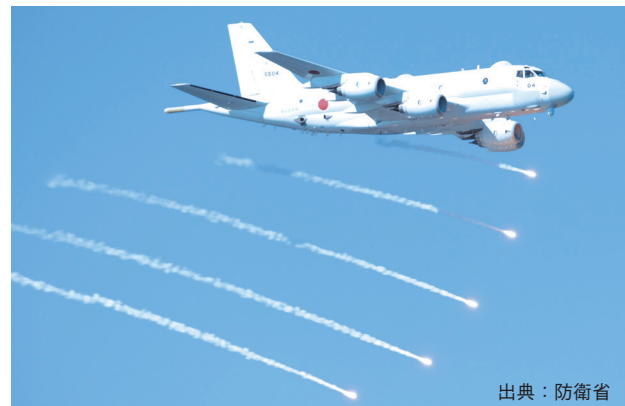
図1 フレア射出によるミサイル回避 Fig. 1 Avoiding missiles by deploying flares
