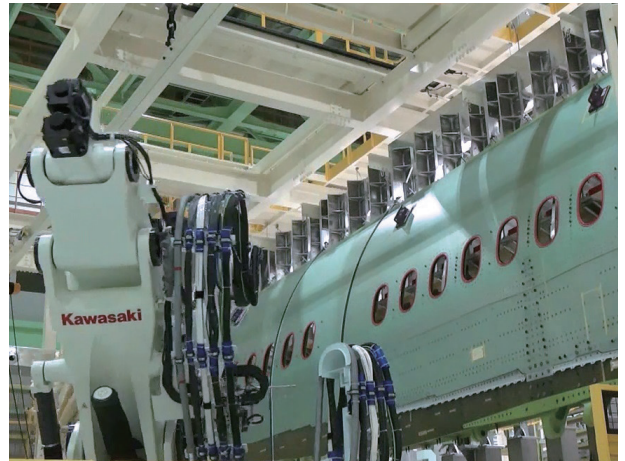
図13 大径穿孔ロボットシステム
