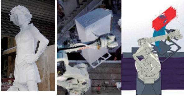
図5 テーマパーク用の立体造形切削 Fig. 5 Tridimensional formative cutting for theme park
