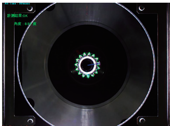
図5 インプットシャフト歯面計測 Fig.5 Input gear measurement
