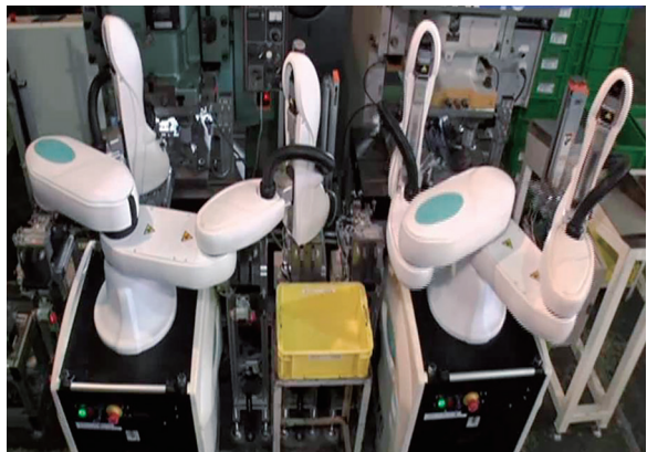
図7 プレス機へのローディング／アンローディングの適用 Fig. 7 Application of loading/unloading for pressing machine
