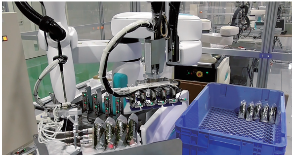
図8 おにぎりの番重詰めへの適用 Fig.8 Application to rice ball packaging
