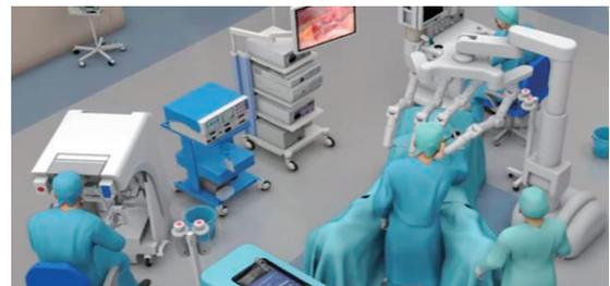
図7 腹腔鏡手術支援ロボットシステムのイメージ
