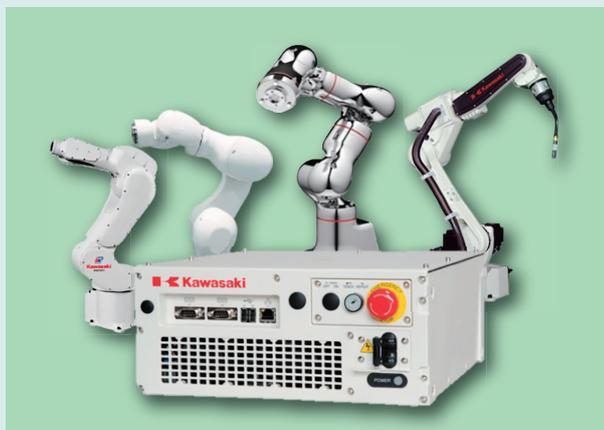
カワサキのロボットコントローラが新世代に突入する。当社は、小型ロボット用コントローラとして「F60」を開発した。本製品は、従来の「E7xシリーズ」に対して体積約77%減、質量約72%減を実現することで、業界において世界最小サイズ、最軽量を達成した。さらに最新のエレクトロニクス技術を活用することで、機能・性能面も大幅に向上させ、省エネ効果も高めた製品である。
