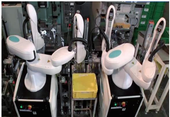
図7 プレス機へのローディング／アンローディングの適用
