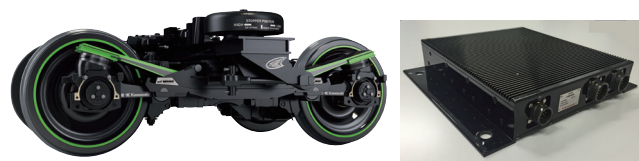
図5 「efWING」と台車搭載型監視ユニット Fig.5 efWING and bogie-mounted monitoring unit
