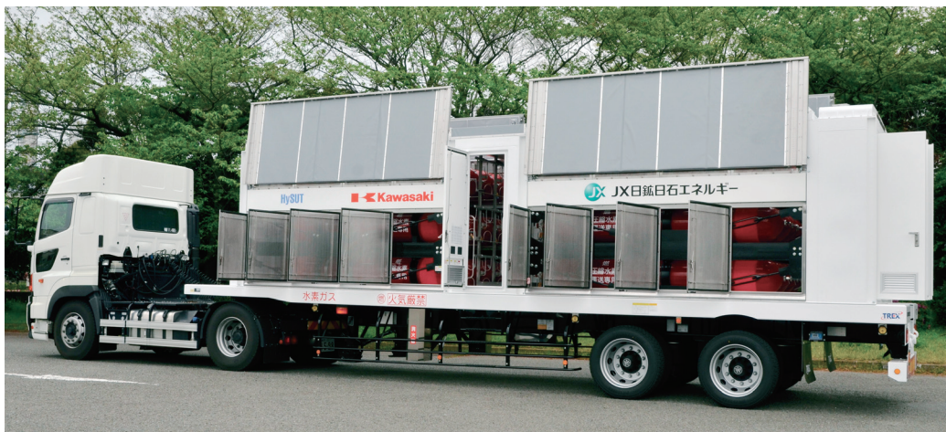
高圧水素ガストレーラー
