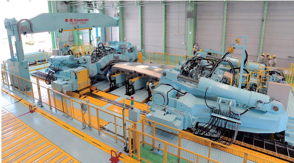
航空機の「顔」とも言えるフロント部分の外板。滑らかな美しい3次元曲面を描くこの金属板は、長さ8m、厚み0.3～5mmという薄く巨大なフラット板を金属成形加工技術「シートストレッチャ」によって自動成形したもの。従来、熟練作業者が経験をもとに手動で行ってきた成形加工を機械による完全自動化へ。その挑戦の道のりをご紹介します。
