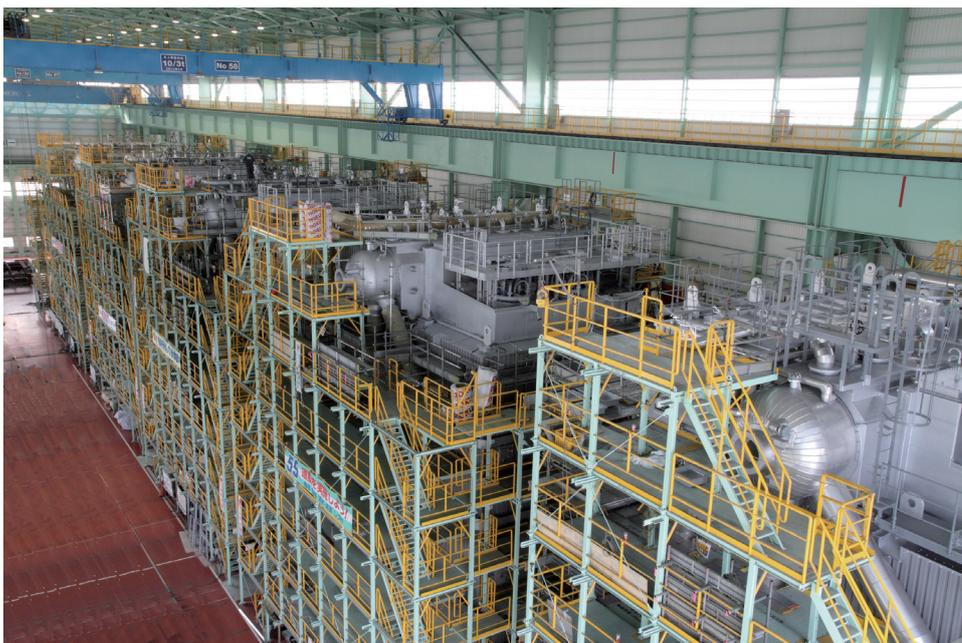
浮体式海洋天然ガス液化プラント (FLNG) 用ボイラ生産工場
