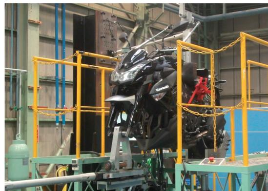
図12 ロードシミュレータによる耐久試験
