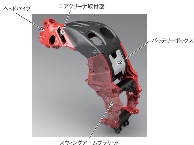
図10 アルミニウムモノコックフレームの変更部 Fig.10 Modified components of the aluminum monocoque frame
