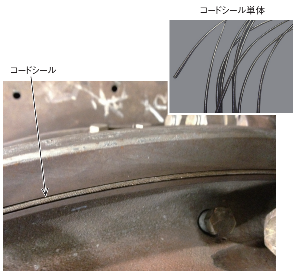
図7 コードシールによる隙間の削減 Fig. 7 Gap minimization by applying cord seal
