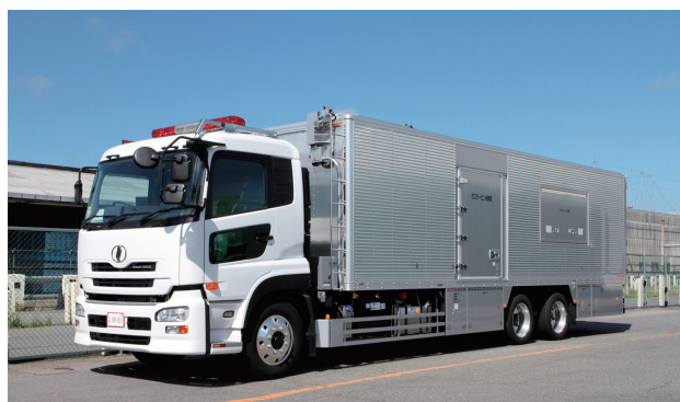
図5 移動電源車 Fig.5 Mobile power unit
