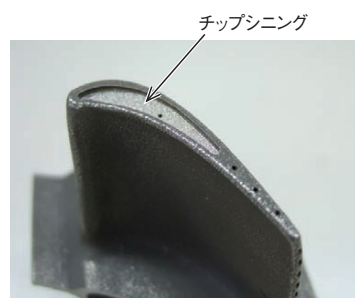
図4 チップシニング構造 Fig. 4 Tip thinning structure
