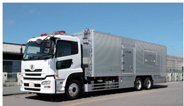
図5 移動電源車 Fig.5 Mobile power unit
