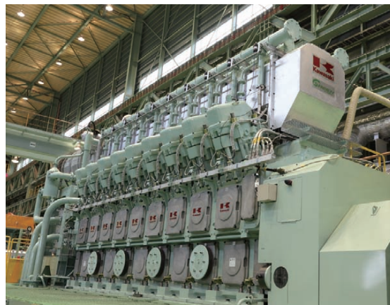
図7 7.8MWカワサキグリーンガスエンジン
