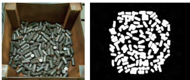
(a) 鍛造素材ワーク (b) 領域分割処理画像
