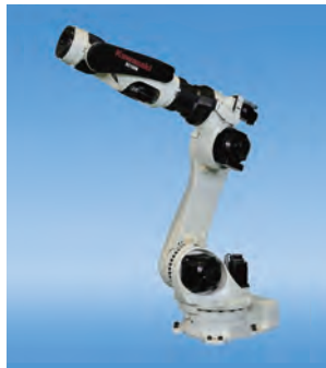
配線、配管は全て旋回部中心に配置
