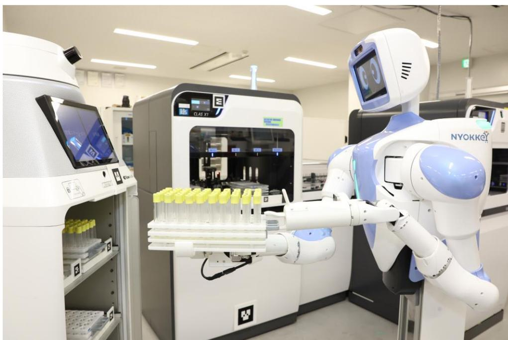
藤田医科大学（以下、藤田医大）と川崎重工業株式会社（以下、川崎重工）は、医療従事者の負担軽減・業務効率化による、質の高い医療の持続的提供の実現に向けた取り組みとして、藤田医科大学 岡崎医療センター（愛知県岡崎市）にて、川崎重工の屋内配送用サービスロボット「FORRO（フォーロ）」とアーム付き自律走行型サービスロボット「Nyokkey（ニョッキー）」の2種類のサービスロボットを連携させた実証実験に成功しました。なお、今回の成功は、ロボットの連携による臨床検体の配送から臨床検査機器への投入までの自動化を実現した世界初の事例<sup>※</sup>です。
