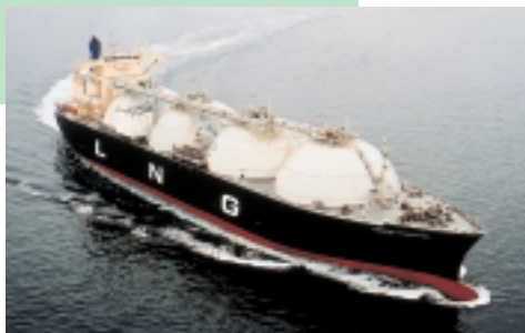
145,000m 3 型LNG運搬船「エネルギーフロンティア」
