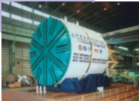
首都高速中央環状新宿線トンネル工事向けシールド掘進機
