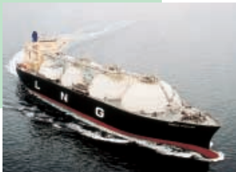
145,000m 3 型LNG運搬船「エネルギーフロンティア」
