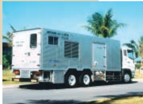
沖縄電力株式会社向け移動発電機車
