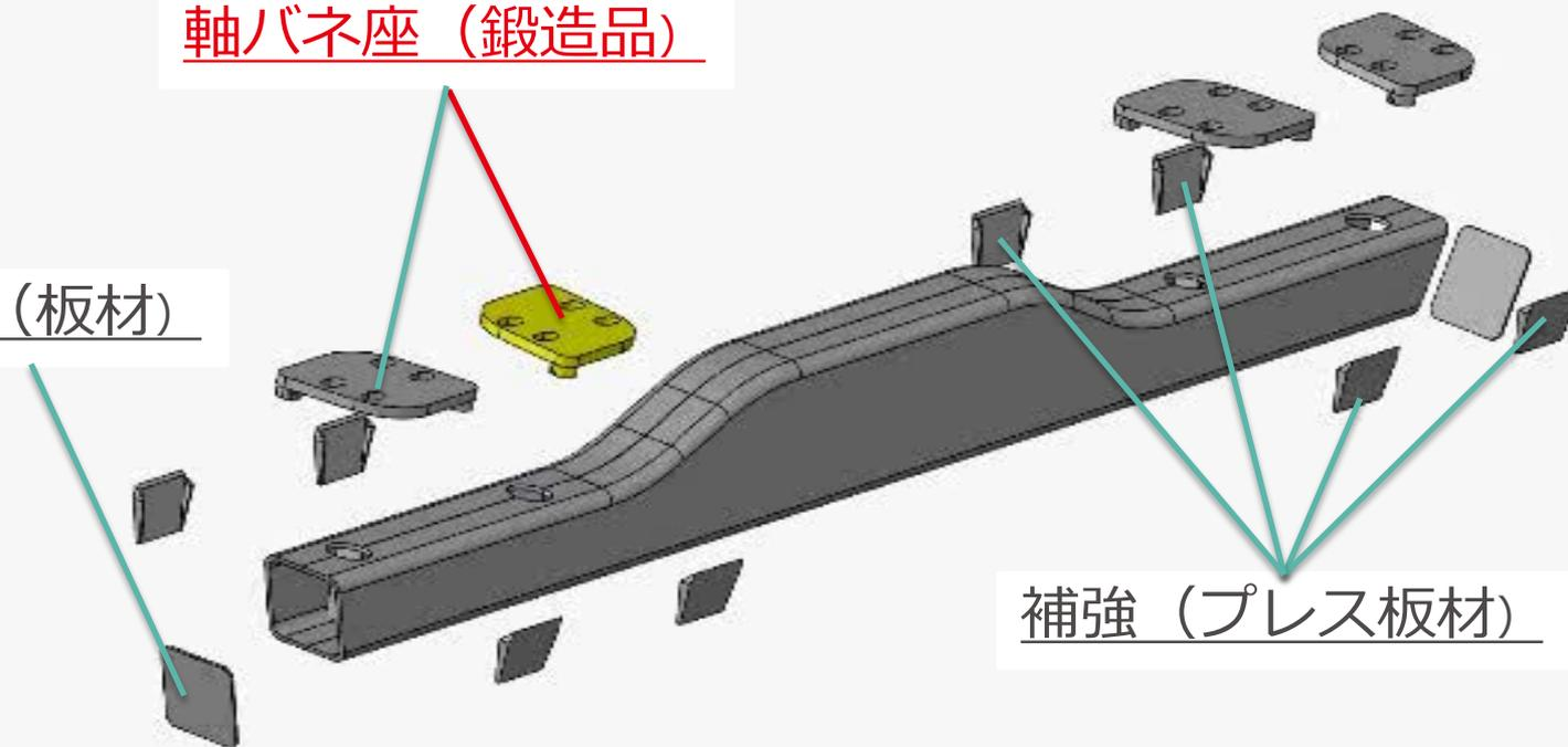
軸バネ座・フタ・補強を溶接にて取付け、完成します
