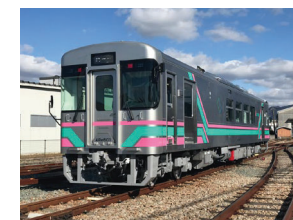
甘木鉄道(株)向け ARe500形電気式気動車 (Green DEC)
