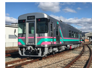
甘木鉄道(株)向け ARé500形電気式気動車 (Green DEC)
