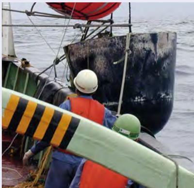
熱防護材料「アブレータ」で覆われた回収カプセル
