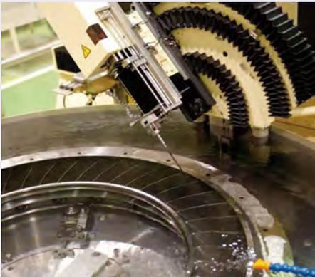
ジェットエンジン部品の高速放電加工
