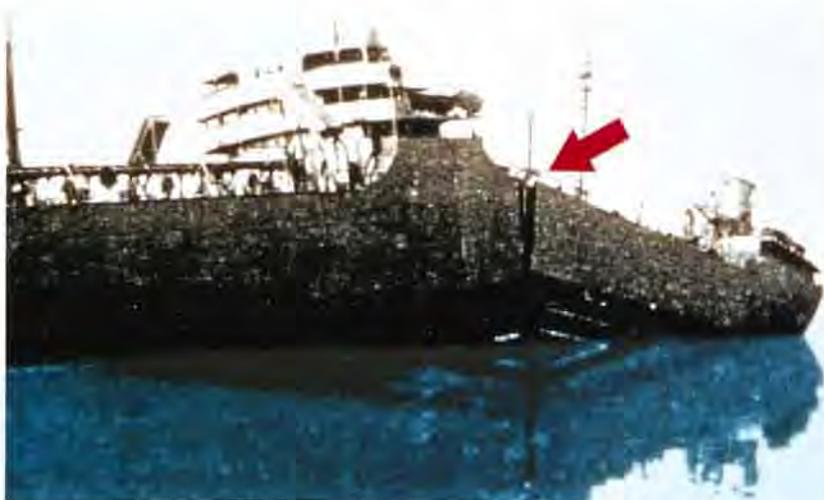
脆性破壊した船体
