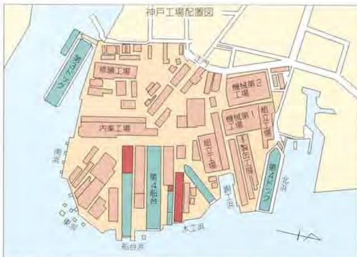
設備削減した神戸工場の船台（■の部分）
