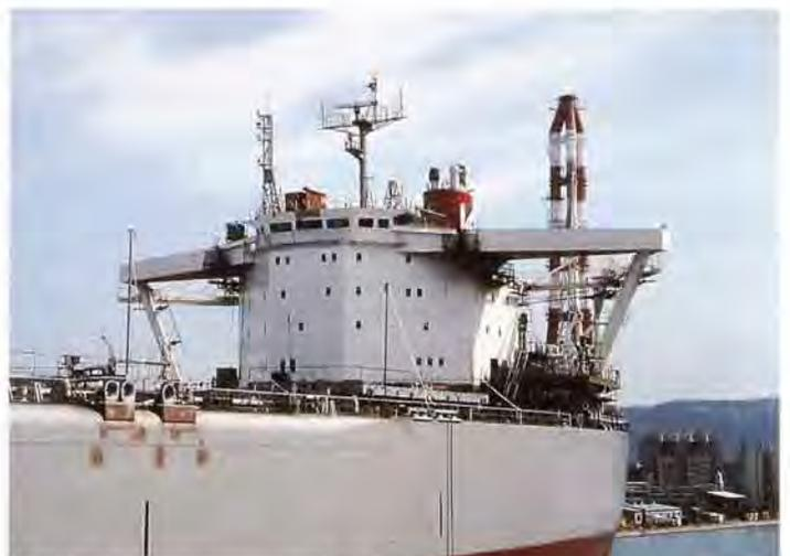
鋳石兼石炭運搬船「千城川丸」（1983年3月10日引渡）のくさび形船橋
