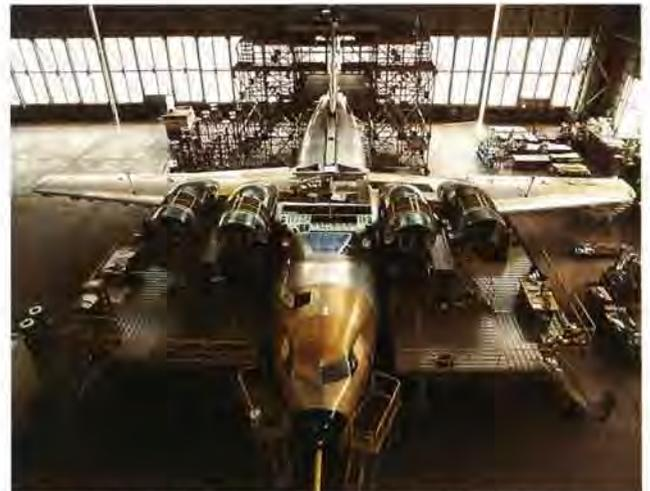
最終組立作業中のSTOL実験機「飛鳥」（1986年3月31日引渡）／岐阜工場
