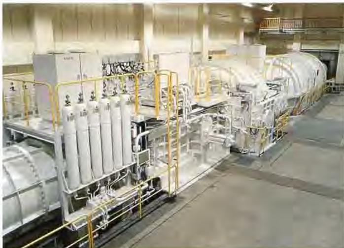
3次元遷音速風洞／岐阜工場
