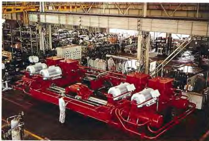
47万重量トン級タンカー用電動油圧舵取機——1972年6月納入
