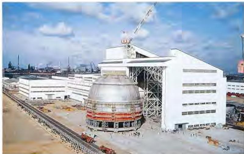
完成した当社製LNG運搬船第1船用球形タンク/播磨工場(1976年1月6日)
