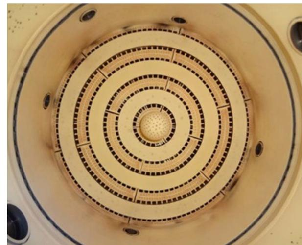
2時間の試験後の燃焼器内部
