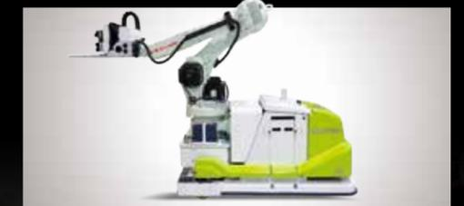
中型汎用ロボット「RS080N」に無人搬送車（AGV）を組み合わせたパッケージ商品で、コンテナからのケースの荷降ろしを自動化します。
