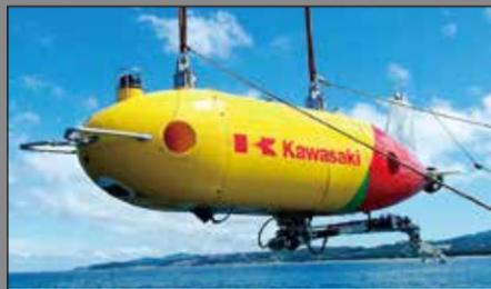
自律型无人潜水机 (AUV)
