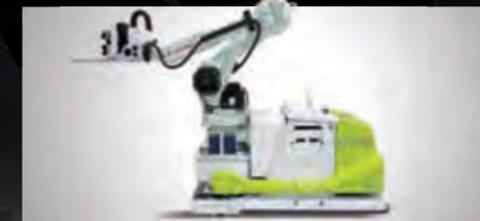
該機器人是將中型通用機器人「RS080N」與無人搬運車(AGV)組合而成的一款套裝產品，用於實現從集裝箱卸貨的自動化。透過對高速、高精度三維視覺系統「K-VStereo」附加AI功能，Vambo可以即時自動識別箱子的大小、位置偏移和傾斜。此外，應用自主研發的取貨手臂，即使對於直放或尺寸不同的箱子，也能夠同時取出多個箱子，實現各種條件下的自動卸貨。
