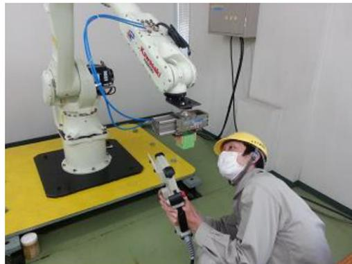
(例 3) ロボットが停止状態中、ある作業者が安全柵内で作業をしています。
