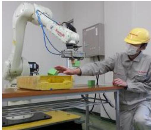
(例 2) 作業者が教示の為、ロボットのツール先端に近寄り作業しています。
