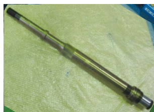
納入後20年経過による全体的な発錆
