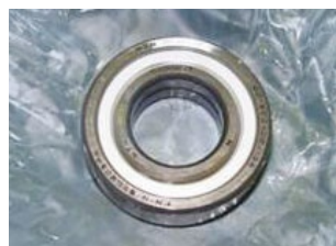
長時間運転(1,000時間超)及び納入後30年経過によるベアリング破損
